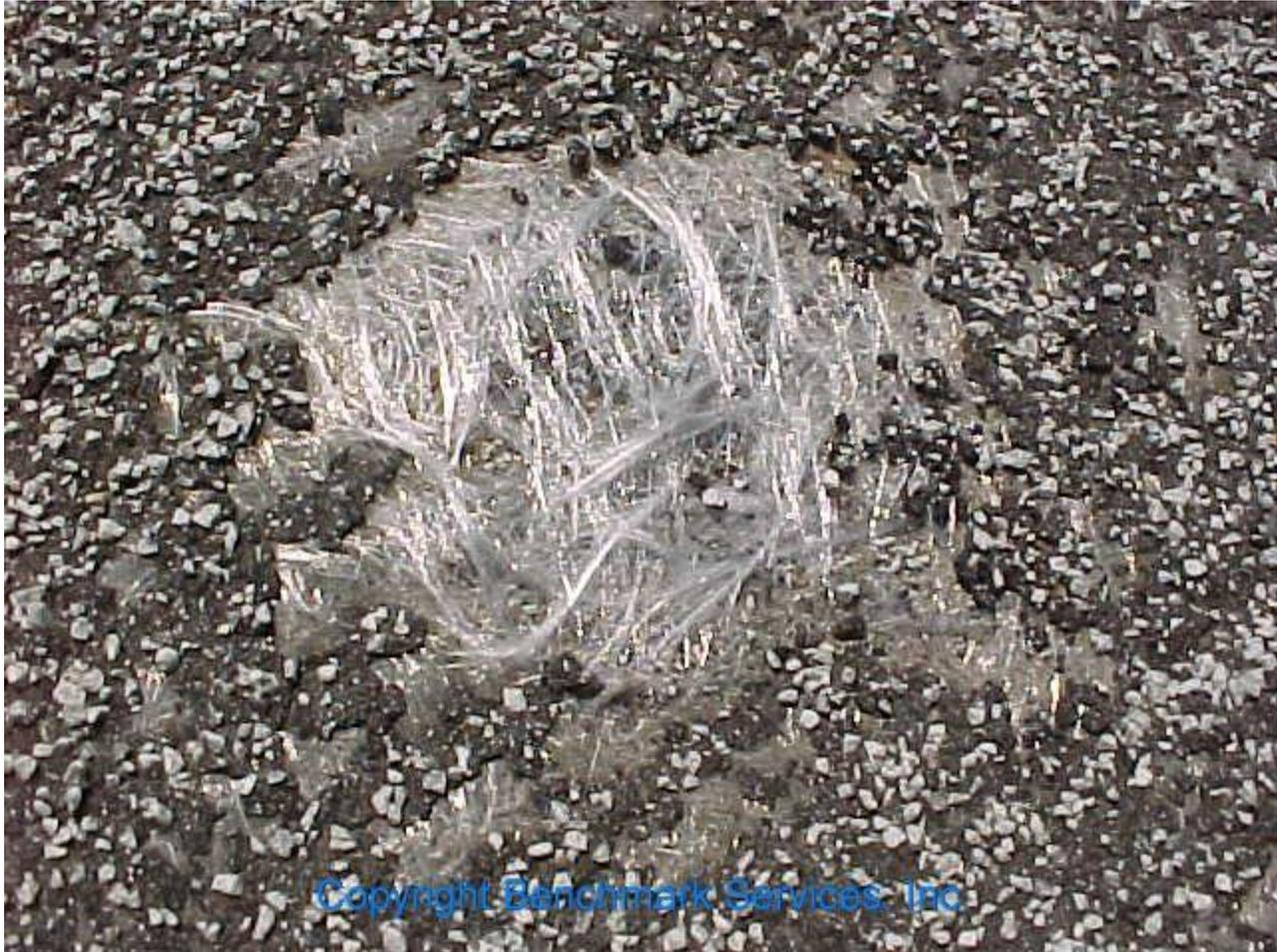
Abbildung 5 - Verschiebung von SBS modifiziertem Bitumendachgranulat durch Hagelschlag
