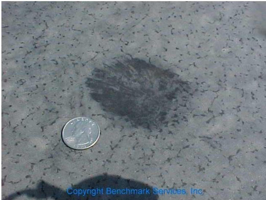
Abbildung 10 - EPDM-Dachbahn von 2 1/2" (6,35cm) Hagel getroffen, keine Beschädigung der Dachbahn
