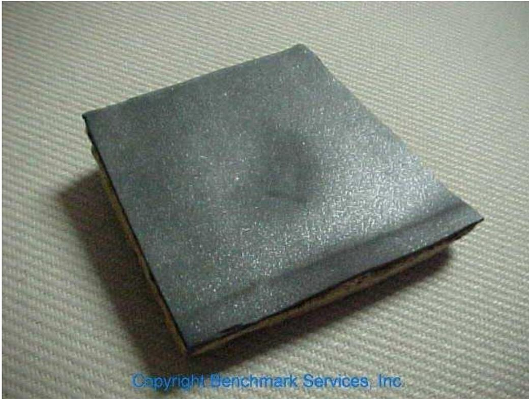
Abbildung 11 - EPDM vollständig auf der Faserplattenisolierung verklebt, keine Beschädigung der Membrane
