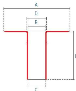
Der DACHPROTECT EPDM Klebe-Gully ist in den Nennweiten (DN) 50 bis 150 erhältlich. Der Flanschdurchmesser (A) beträgt je nach Ausführung 235 bis 380 mm. Der Stutzen (h) kann auf die gewünschte Länge gekürzt werden.
